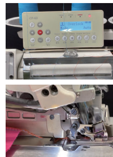
■ ATC 自動テープカット装置（センサー式） for JJ 自動、半自動で縫製前後の糸生地始末（カット）を行います。 Auto tape cutting device Automatically or semi-automatically cuts the thread fabric before and after sewing.
