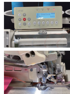
■ ATC 自動テープカット装置（センサー式） for JJ 自動、半自動で縫製前後の糸生地始末（カット）を行います。 Auto tape cutting device Automatically or semi-automatically cuts the thread fabric before and after sewing.
