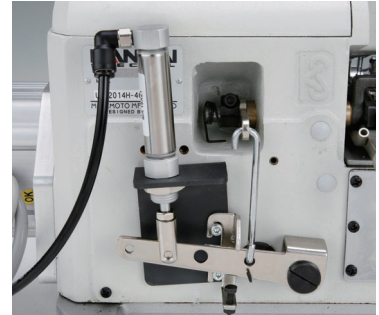
■ FL エア式押さえ上げ装置 for JJ Air type foot lifter for JJ
